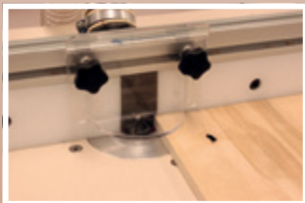
Läpinäkyvä teräsuojus on näppärä kiinnittää eri korkeuksille.
